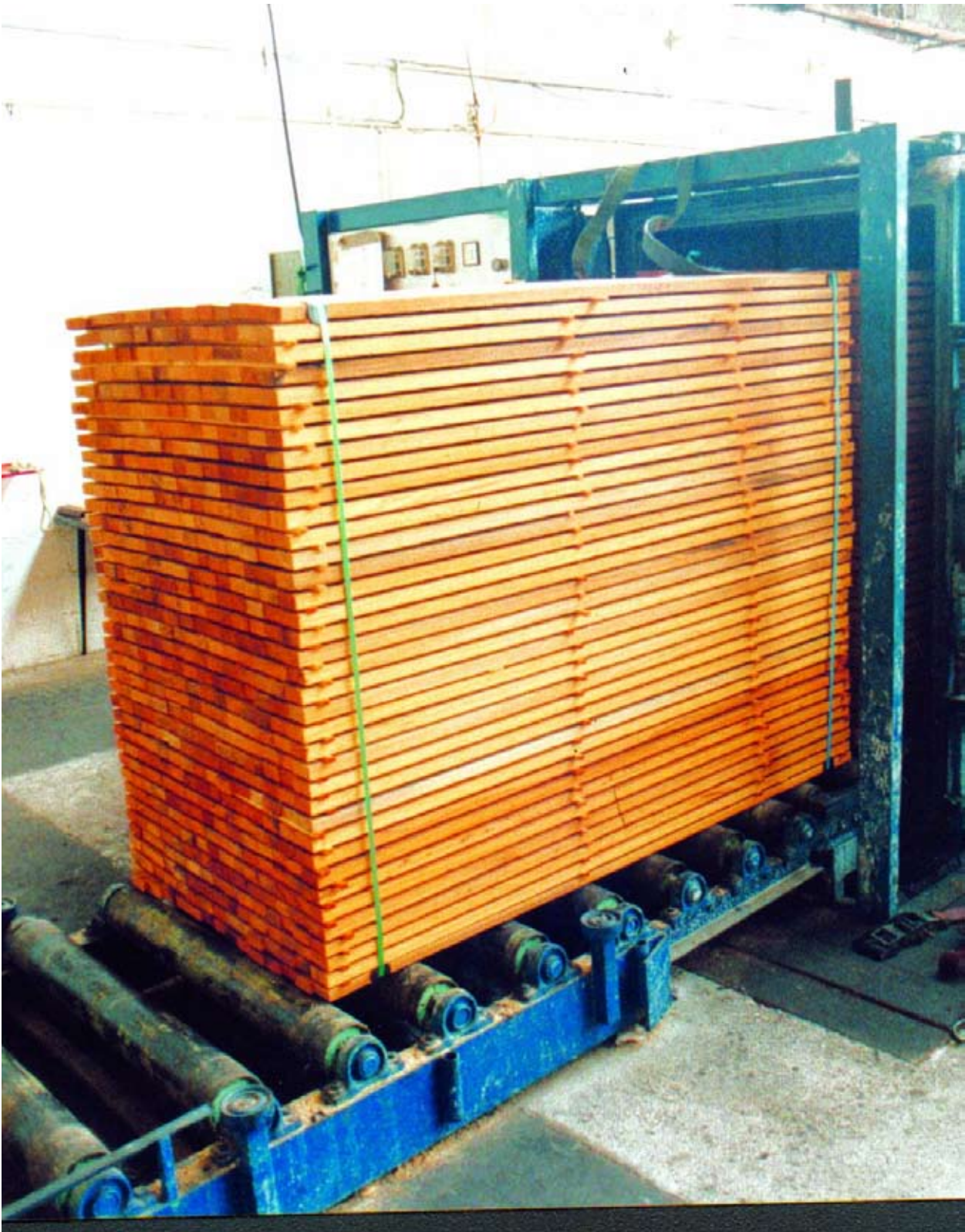
Introducción de un lote de madera en autoclave para tratarla con producto ignífugo
